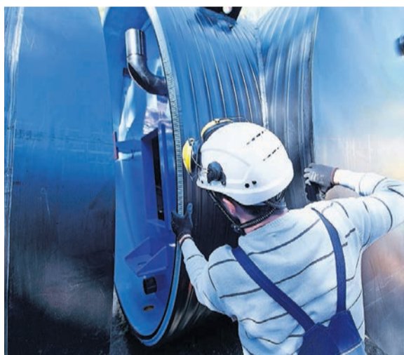
Handarbeit. Die einzelnen Elemente der bis zu 23 Meter langen Röhren werden in diesen Tagen zusammengesweisst.
